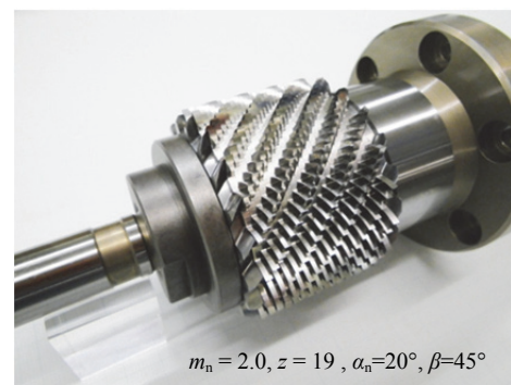
図7 スクレイピングカッタによる特殊歯車試作例
